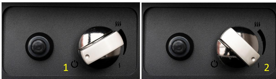
Fig 7 – Accensione del dispositivo
